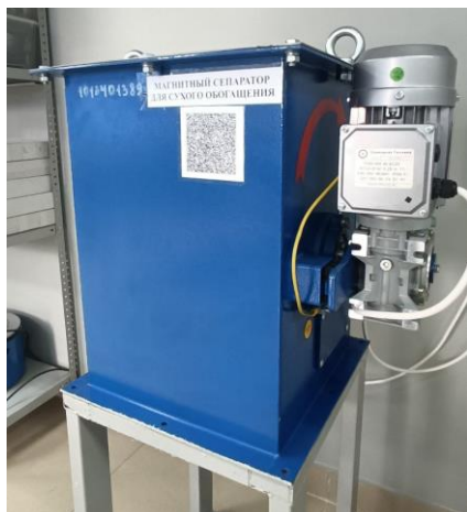
Рисунок 1 -Магнитный сепаратор для сухого обогащения PDW-050
