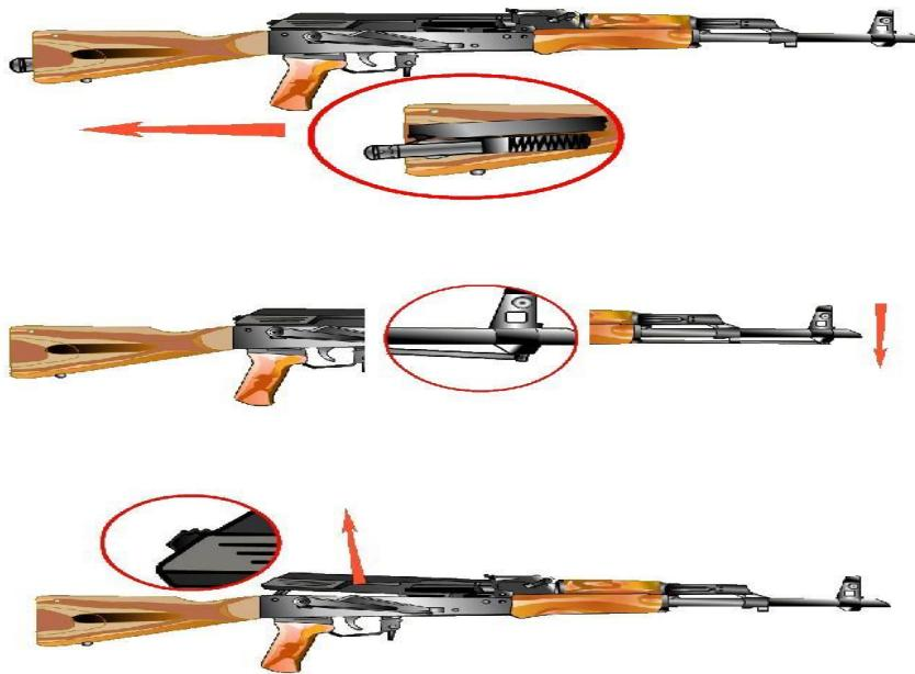
3. Отделить шомпол. Оттянуть конец шомполя от ствола так, чтобы его головка вышла из-под упора на основании мушки, и вынуть шомпол вверх. При отделении шомполя разрешается пользоваться выколоткой.
