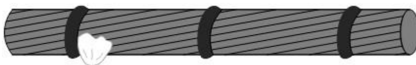
Рисунок. Провод с кольцами, препятствующими скольжению снега
