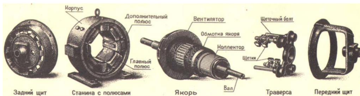
Рис. 3 Электродвигатель постоянного тока открытого исполнения в разобранном состоянии.
