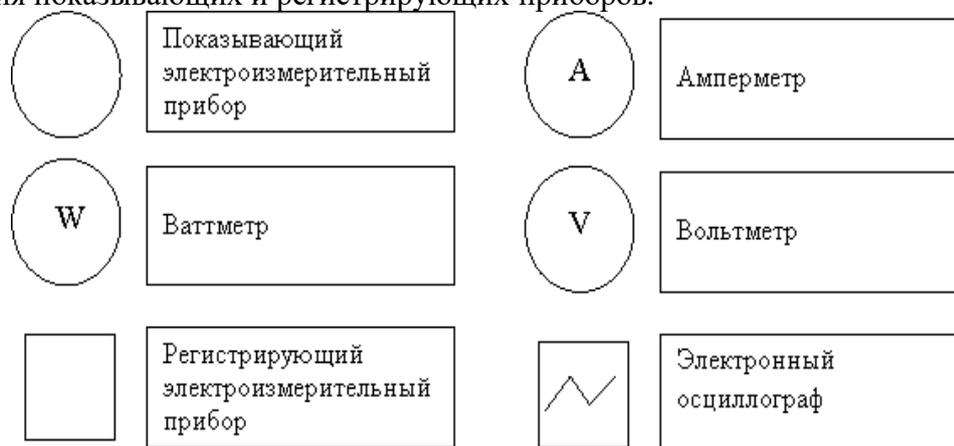
Условные графические обозначения электроизмерительных приборов.
