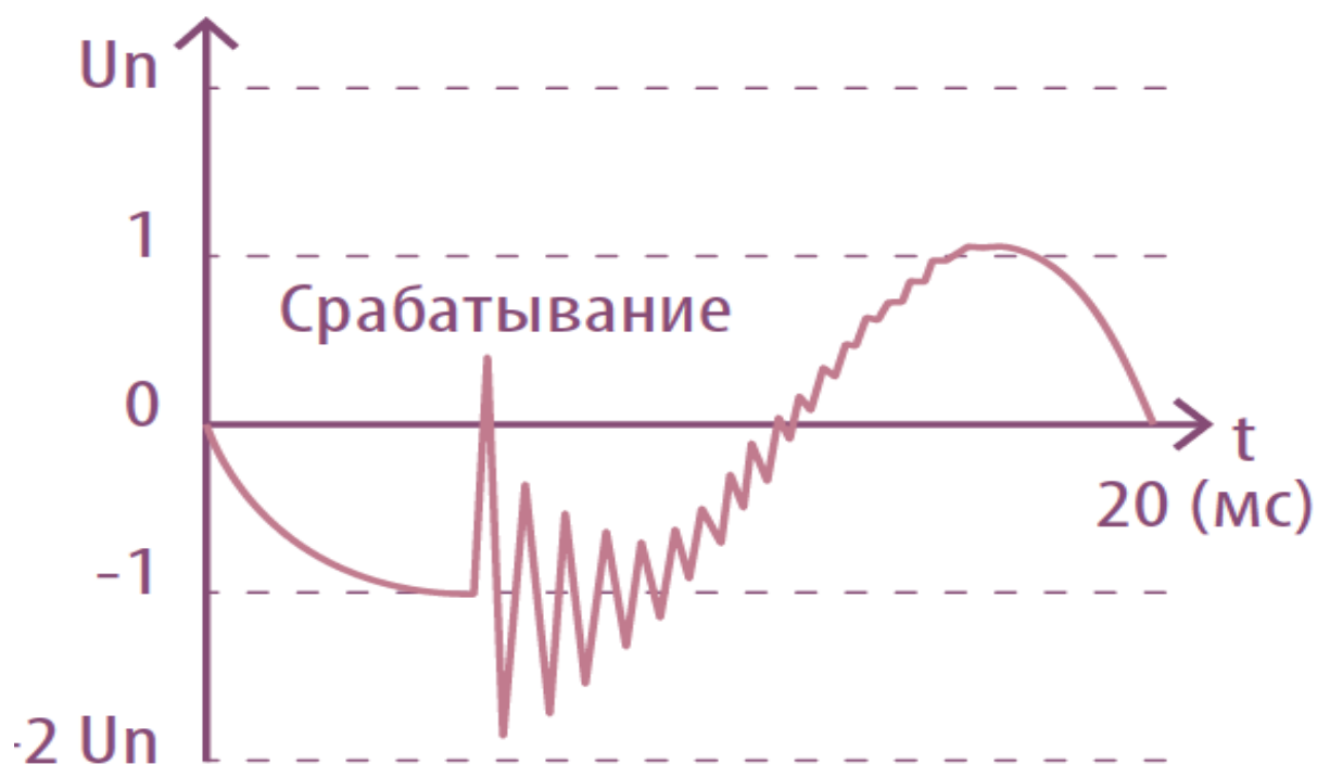
Рисунок 4- Типичная форма коммутационных перенапряжений
