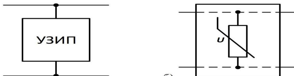
Рисунок 2- УЗИП одновводные: общее обозначение а), одновводное УЗИП с отдельными
