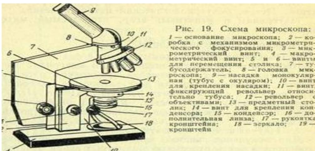
Рис. 19. Схема микроскопа:
