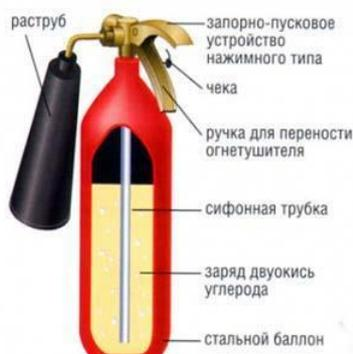
**Принцип действия** основан на вытеснении двуокси углерода избыточным давлением собственных паров. При открывании пускового устройства углекислый газ по сифонной трубке поступает к раструбе. СО из сжиженного состояния переходит в газообразное. Углекислота, попадая на горящее вещество, изолирует его от воздуха.
